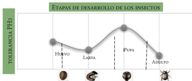
Tolerancia a la fosfina (PH 3 ) en las distintas etapas de desarrollo de los insectos.
